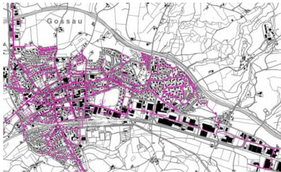
Abbildung 8: Erdgasversorgungsnetz Stadt Gossau (2)
